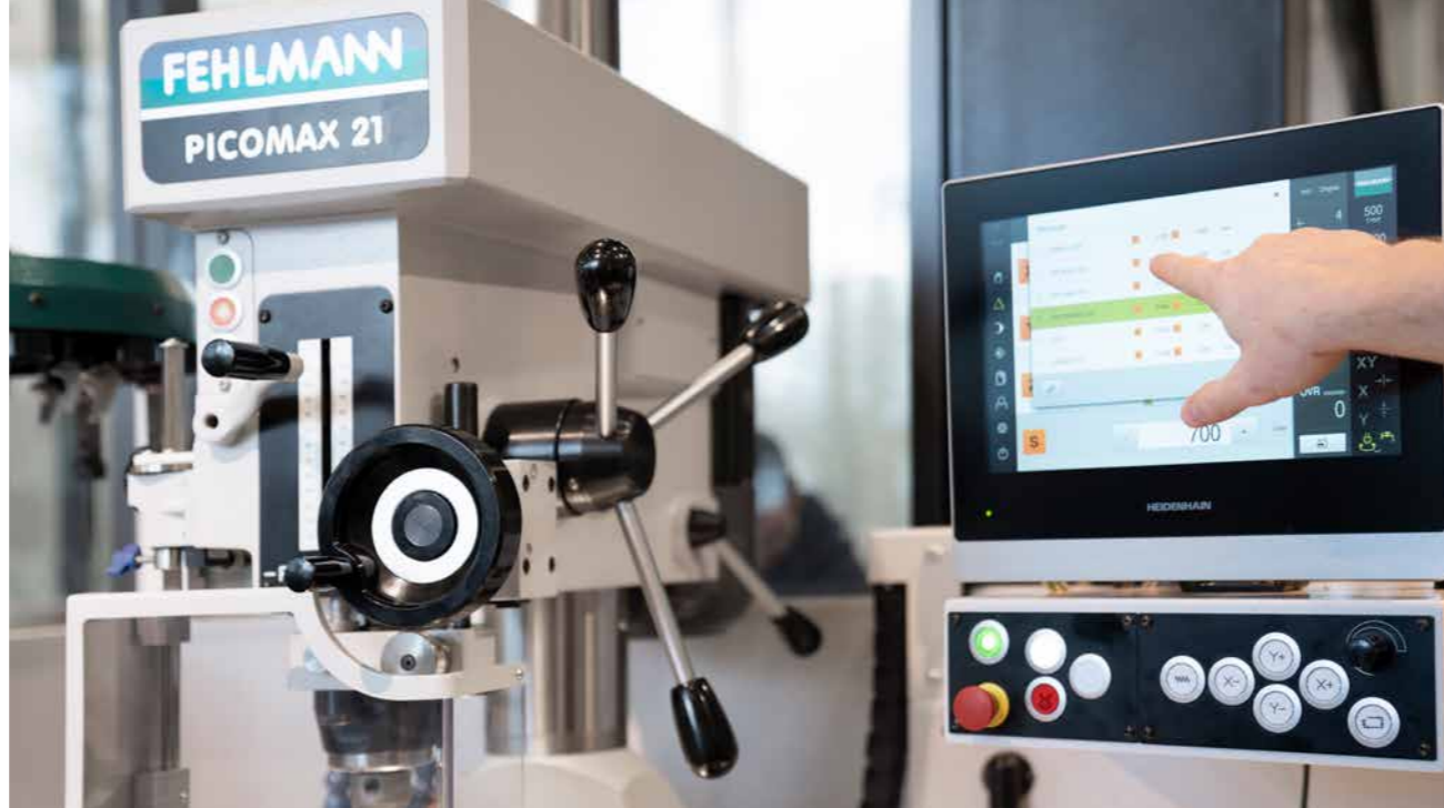
Máquina manual con mesa de posicionamiento y POSITIP 8000 ACTIVE: así sustituye la FEHLMANN PICOMAX 21-M a las máquinas CNC sencillas.
