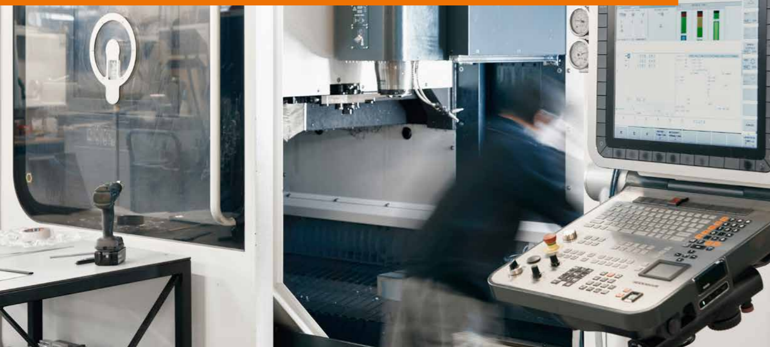
En el taller hay disponibles para el aprendizaje, entre otras cosas, dos fresadoras DMG con controles numéricos HEIDENHAIN de tipo iTNC 530.
