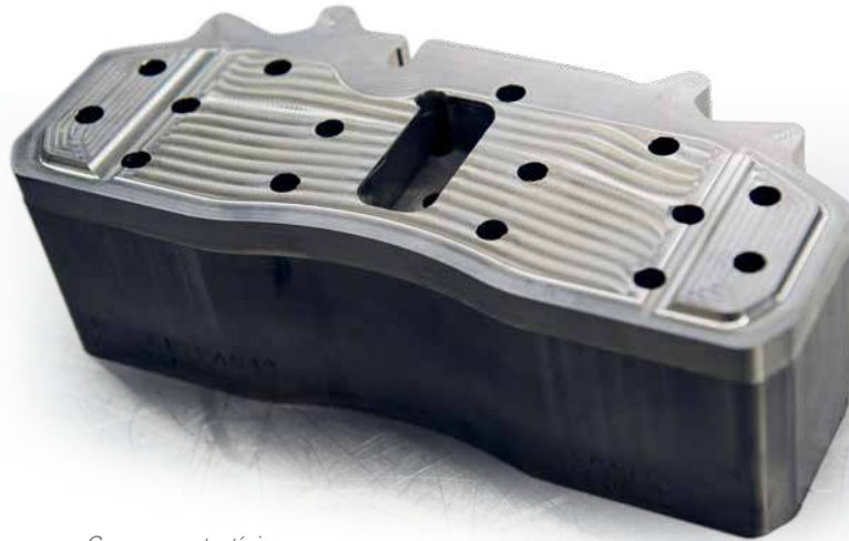
Componente típico: El molde para el estampado de una placa portadora para zapatas de freno de camiones...
